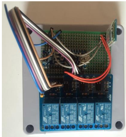
ภาพที่ 2 แสดงพีซีบีบอร์ดที่กำหนดช่องสัญญาณ 4 ช่อง เพื่อทำการเชื่อมต่อเข้ากับอุปกรณ์ไฟฟ้าต่าง ๆ
